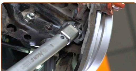
**45** Pingutage kinnitust, mis ühendab õõtsuuba ja auto raami. Kasutage kombivõtit Nr. 19. Kasutage padrunit Nr.19. Kasutage momentvõtit. Pingutage seda 70 Nm pöördemomendiga.
