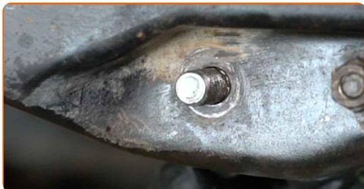
**43** Kinnituste korrektseks pinguldamiseks peate te vedrustuse osad tungraua abil nende tööasendisse tõstma.
