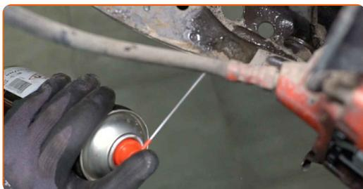
**19** Puhastage kinnitit, mis ühendab põikstabilisaatori varrast õõtsuovaga. Kasutage terasharja. Kasutage WD-40 aerosooli.
