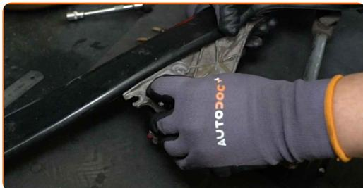
**24** Pinguldage klaasipuhastite mootori kinniteid. Kasutage padrunit Nr.10. Kasutage momentvõtit. Pingutage seda 13 Nm pöördemomendiga.
