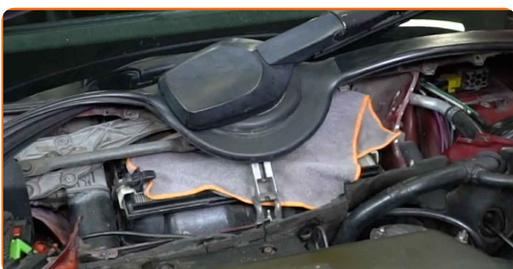
**10** Puhastage klaasipuhastisüsteemi kinnitid. Kasutage terasharja. Kasutage WD-40 aerosooli.
