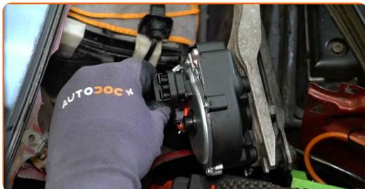
**31** Pinguldage klaasipuhastisüsteemi kinniteid. Kasutage padrunit Nr.10. Kasutage momentvõtit. Pingutage seda 13 Nm pöördemomendiga.
