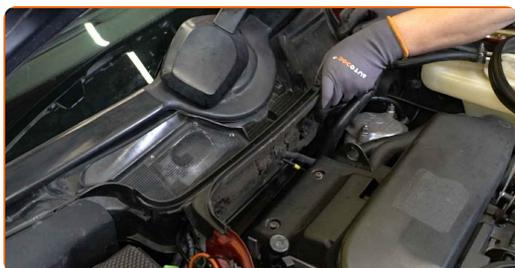
**38** Paigaldage klaasipuhastite aluse võre tihend.
