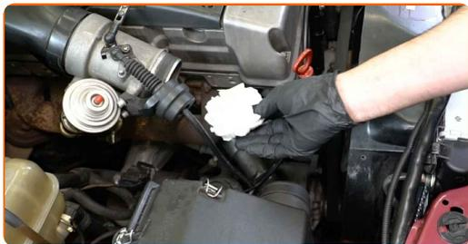
**38** Paigaldage õhu sissevõtukanal ja kinnitage see.
