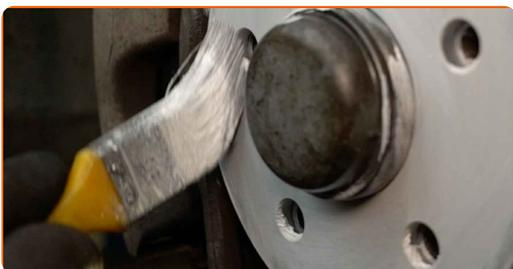
**27** Puhastage piduriketta pind. Kasutage piduri puhastusvahendit.
