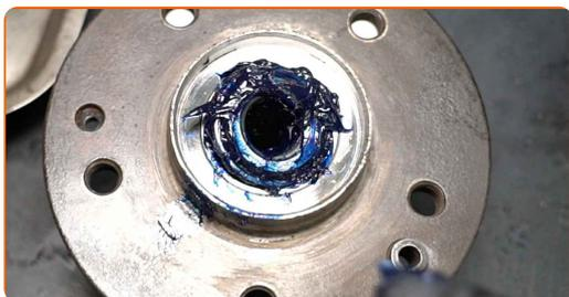
**31** Taaspaigaldage rattarumm koos uute laagritega.
