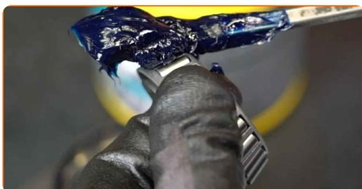
**29** Paigaldage laagrite osad uuesti rattarummu.
