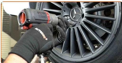
**32** Laske auto alla ja töödake risti järjekorras, pingutage rataste poldid. Kasutage ratta löökpadrunit #17. Kasutage momentvõtit. Pingutage seda 130 Nm pöördemomendiga.
