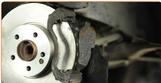
**Vahetamine: piduriklotside – MERCEDES-BENZ SPRINTER 3,5-t Platvorm veoauto/æassii (907, 910). AUTODOCi eksperdid soovitavad:**
