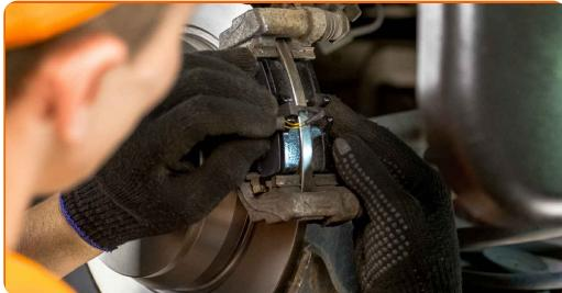
Vahetamine: piduriklotside – MERCEDES-BENZ VITO / MIXTO Kast (W639).
