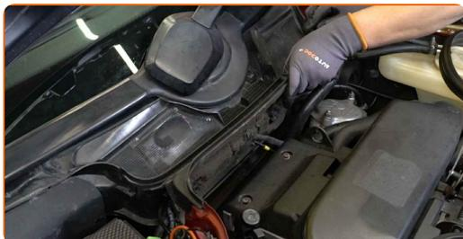
**38** Paigaldage klaasipuhastite aluse võre tihend.
