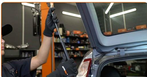
**13** Puhastage pagasiamortide paigalduspesad. Kasutage WD-40 aerosooli.
