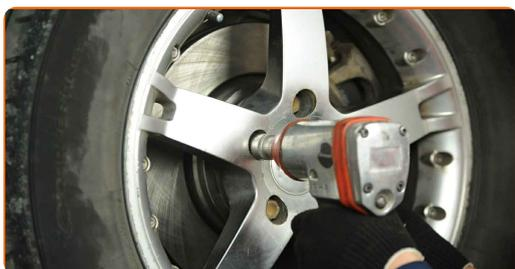
**27** Laske auto alla ja töödake risti järjekorras, pingutage rataste poldid. Kasutage ratta löökpadrunit #19. Kasutage momentvõtit. Pingutage seda 180 Nm pöördemomendiga.
