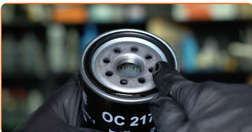
**15** Paigaldage uus õlifilter.
