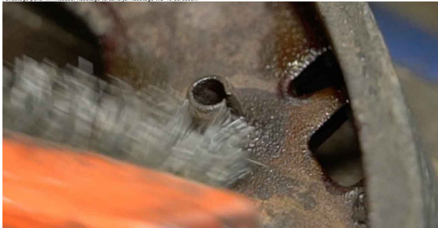
30 Eemaldage puksi. Kasutage veepumba tange.
