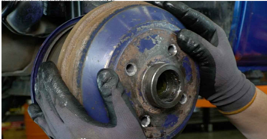
Vahetamine: trummepiduri klotside - OPEL Astra F CC (T92). Soovitus AUTODOC'i ekspertidelt:
