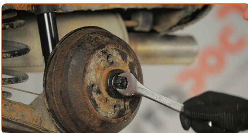
**24** Paigaldage rummu laagri kinnitusmutri splint. Kasutage ümara otsaga tange.
