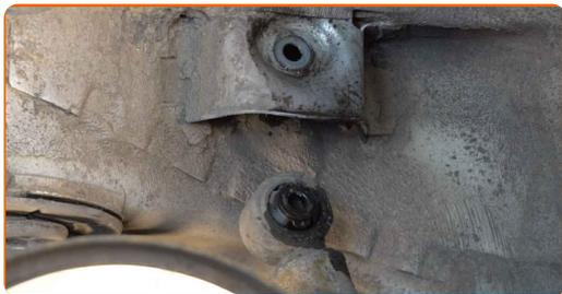
**13** Puhastage amortisaatorite paigalduskohad. Kasutage terasharja. Kasutage WD-40 aerosooli.
