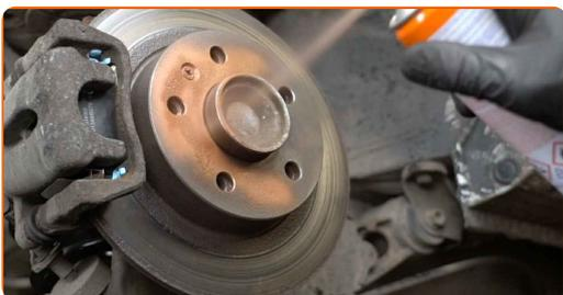
**25** Puhastage piduriketta pind. Kasutage piduri puhastusvahendit.
