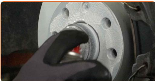
**23** Puhastage piduriketta pind. Kasutage piduri puhastusvahendit.
