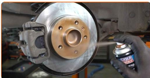
**24** Puhastage piduriketta pind. Kasutage piduri puhastusvahendit.
