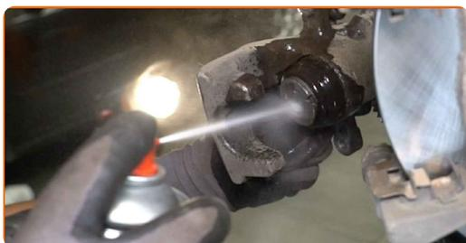
**Vahtamine: piduriklotside – OPEL Corsa C Hatchback (X01). AUTODOCi eksperdid soovivad:**
