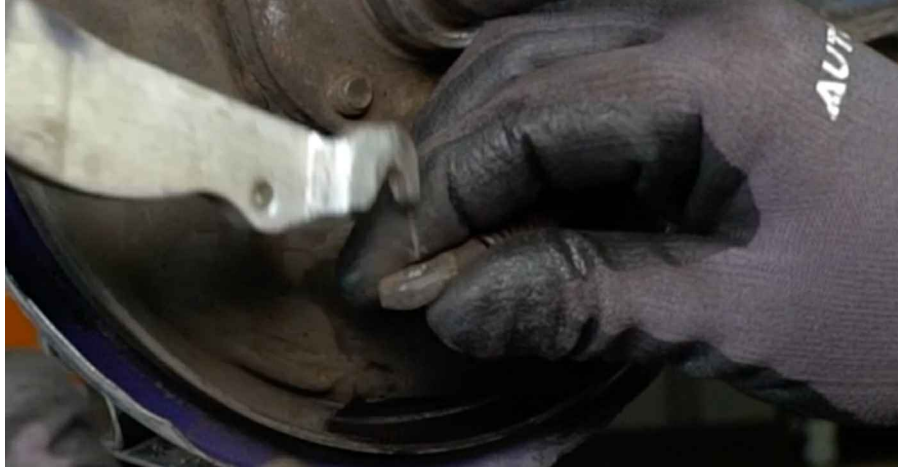
21 Eemaldage vasakpoolne piduriklots.
