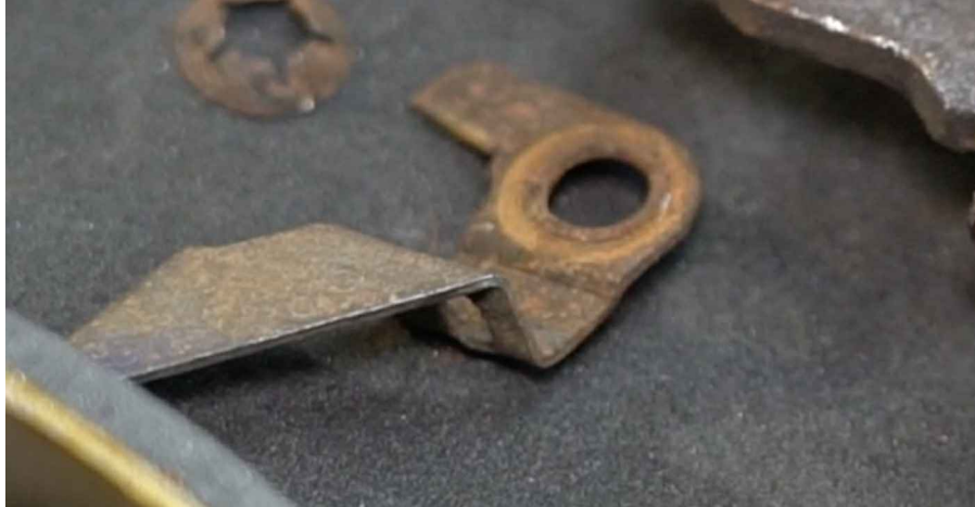
29 Puhastage puksi kinnitusase. Kasutage terasharja. Kasutage WD-40 aerosooli.
