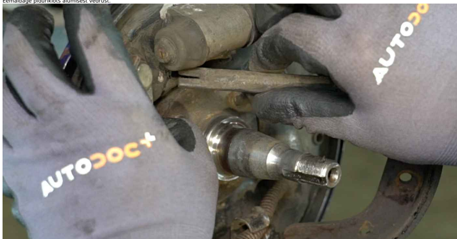
18 Eemaldage parempoolne piduriklots.
