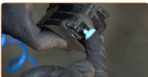
**29** Paigaldage piduriklotsid.
