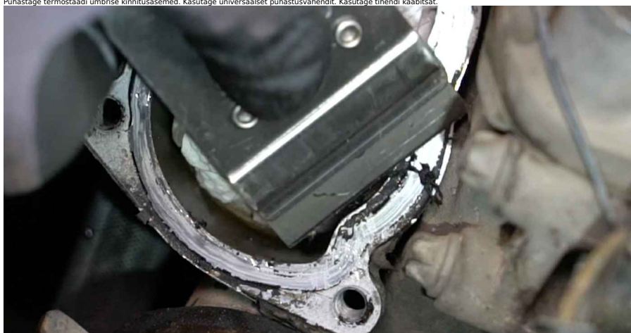
25 Paigaldage uus termostaadi ümbris koos termostaadiga.
