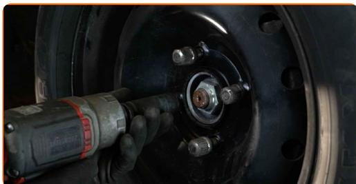
**24** Laske auto alla ja töödake risti järjekorras, pingutage rataste poldid. Kasutage ratta löökpadrunit #19. Kasutage momentvõtit. Pingutage seda 90 Nm pöördemomendiga.
