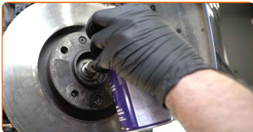
**22** Puhastage piduriketta kinnitused. Kasutage terasharja. Kasutage WD-40 aerosooli.
