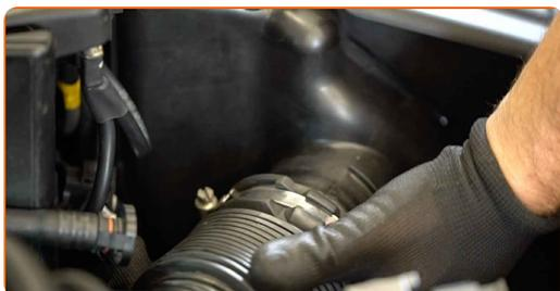
32 Pingutage sidusklambreid, mis kinnitavad õhukanalit õhufiltri korpuse ja turbokompressori. Kasutage kombivõtit Nr. 7.
