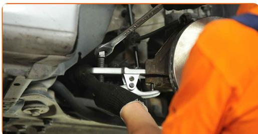
**14** Puhastage kinnitit, mis ühendab õõtshooba kuulliigendiga. Kasutage terasharja. Kasutage WD-40 aerosooli.
