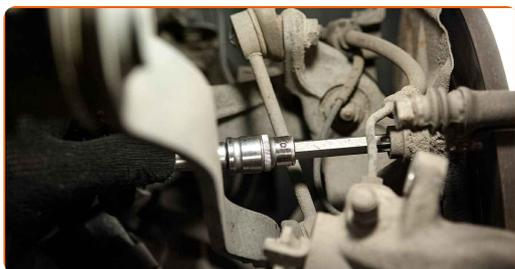
**32** Paigaldage piduriklotsid.
