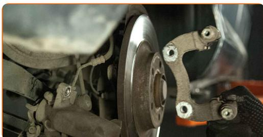
**14** Puhastage piduriketta kinnitused. Kasutage terasharja. Kasutage WD-40 aerosooli.
