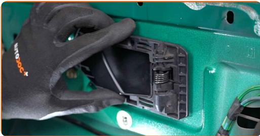
**13** Laske klaasi allapoole, et te näeksite kinniteid, mis ühendavad seda klaasitõstuki mehhanismiga.
