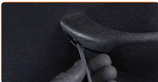
**32** Kinnitage klaasitõstuki mehhanismi reguleeritav käepide.
