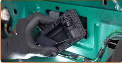
**12** Kinnitage klaasitõstuki mehhanismi reguleeritav käepide.
