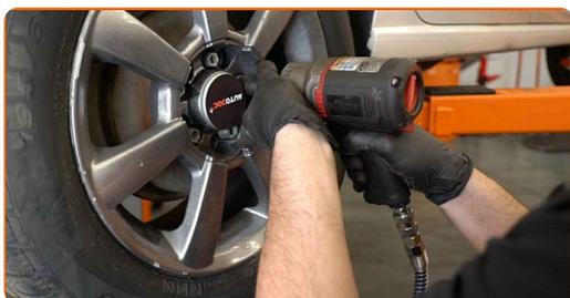
**39** Laske auto alla ja töödake risti järjekorras, pingutage rataste poldid. Kasutage ratta löökpadrunit #17. Kasutage momentvõtit. Pingutage seda 120 Nm pöördemomendiga.
