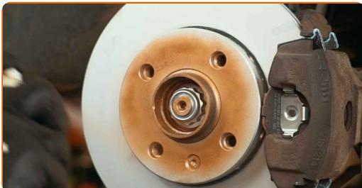
**19** Puhastage piduriketta pind. Kasutage piduri puhastusvahendit.
