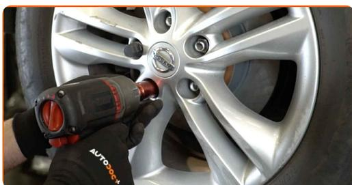
**33** Laske auto alla ja töödake risti järjekorras, pingutage rataste poldid. Kasutage ratta löökpadrunit #21. Kasutage momentvõtit. Pingutage seda 112 Nm pöördemomendiga.
