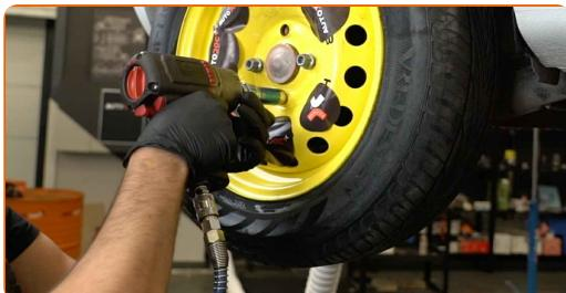
**35** Laske auto alla ja töödake risti järjekorras, pingutage rataste poldid. Kasutage ratta löökpadrunit #17. Kasutage momentvõtit. Pingutage seda 105 Nm pöördemomendiga.
