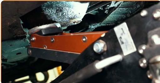
**4** Puhastage mootoritoe kinnitused. Kasutage terasharja. Kasutage WD-40 aerosooli.
