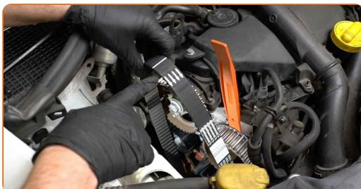
Vahetamine: veepump & hammasrihma komplekt – RENAULT Megane II Hatchback (BM, CM). AUTODOC'i eksperdid soovitavad:
