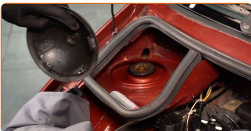
4 Puhastage amordipüstaku ülemised kinnitused. Kasutage terasharja. Kasutage WD-40 aerosooli.
