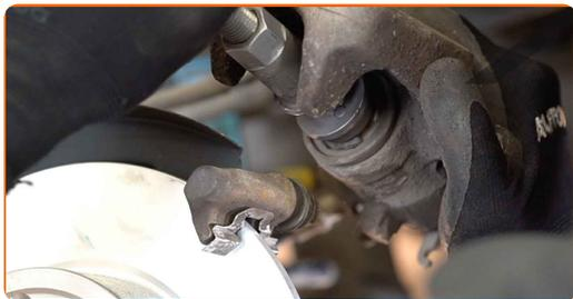
**26** Paigaldage piduriklotsid.
