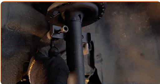
**62** Pingutage kinnitust, mis ühendab stabilisaatorilülid amordipüstakuga. Kasutage padrunit Nr.17. Kasutage momentvõtit. Pingutage seda 44 Nm pöördemomendiga.
