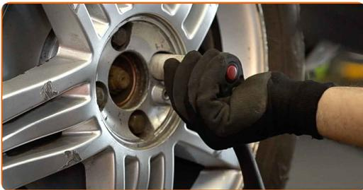
17 Laske auto alla ja töödake risti järjekorras, pingutage rataste poldid. Kasutage ratta löökpadrunit #19. Kasutage momentvõtit. Pingutage seda 110 Nm pöördemomendiga.
