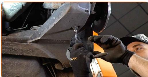
**7** Puhastage amortisaatorite kinnitused. Kasutage terasharja. Kasutage WD-40 aerosooli.
