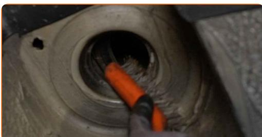
**55** Puhastage kinnitid, mis ühendavad kuulliigendit käänmikuga. Kasutage terasharja. Kasutage WD-40 aerosooli.
