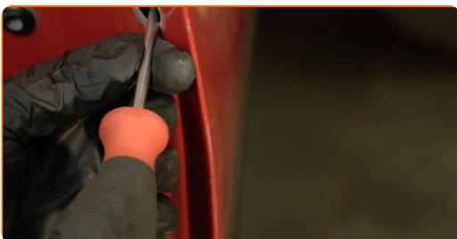
**16** Eemaldage välimise käepideme kinnitusdetaili kate. Kasutage plastikust eemaldajat.
