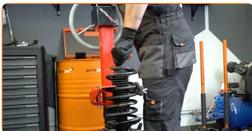
**32** Paigaldage ülemine vedrupüstak ja vedrupüstaku laager.
