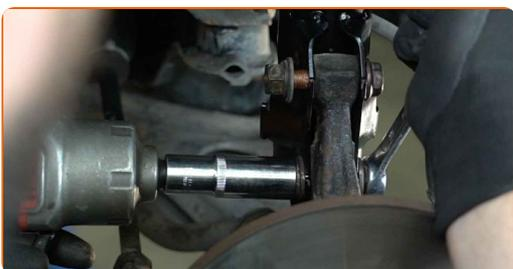
**44** Pingutage alumisi amordipüstaku ja käändtelje vahelisi kinnitusi. Kasutage kombivõtit Nr. 18. Kasutage padrunit Nr.18. Kasutage momentvõtit. Pingutage seda 95 Nm pöördemomendiga.
