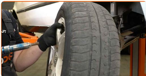
10 Puhastage klambri kinnitused, mis ühendab pidurivoolikut amordipüstakuga. Puhastage kinnitused, mis ühendavad amordipüstakut käändteljega. Kasutage terasharja. Kasutage WD-40 aerosooli.
