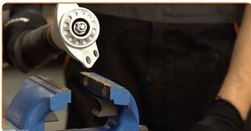
**22** Puhastage amortisaatorite paigalduskohad. Kasutage terasharja. Kasutage WD-40 aerosooli.
