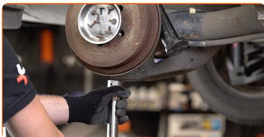
**9** Puhastage amortisaatorite kinnitused. Kasutage terasharja. Kasutage WD-40 aerosooli.
