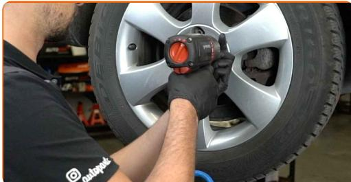
Vahetamine: piduriklotside – SKODA Octavia I Hatchback (1U2). AUTODOC soovitab:
