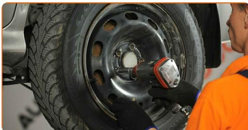
**15** Laske auto alla ja töödake risti järjekorras, pingutage rataste poldid. Kasutage rattalöökpadrunit #17. Kasutage momentvõtit. Pingutage seda 120 Nm pöördemomendiga.
