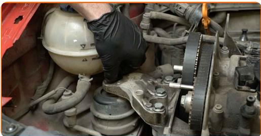
**34** Puhastage mootoritoe kinnitused. Kasutage terasharja. Kasutage WD-40 aerosooli.
