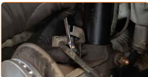
**67** Puhastage stabilisaatorivarrast paigalduspesad. Kasutage terasharja. Kasutage WD-40 aerosooli.
