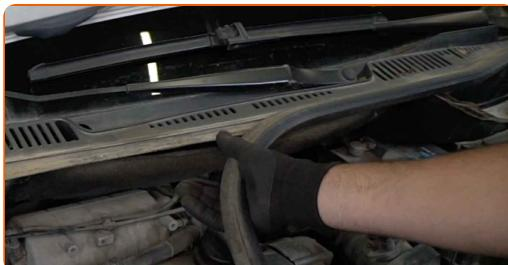
**4** Puhastage klaasipuhastite aluse võre kinniteid. Kasutage terasharja. Kasutage WD-40 aerosooli.
