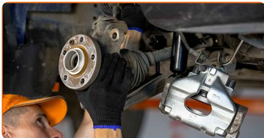
**23** Suruge rattarumm kitsast rull-laagrist välja. Kasutage pukside ja laagrite vahetamiskomplekt. Kasutage haamrit.
