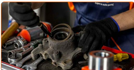
**25** Suruge rattarummu laager välja. Kasutage pukside ja laagrite vahetamiskomplekt.
