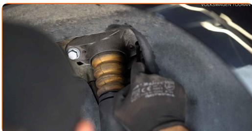
22 Kinnitage amortisaatori aluse kinnitused. Tähelepanu! Kasutage kindlasti uusi kinniteid. Kasutage padrunit Nr.16. Kasutage momentvõtit. Pingutage seda 50 Nm pöördemomendiga.+45°
