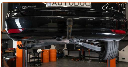
21 Paigaldage amortisaatori vedrupüstak juhindudes paigaldamisel keskmisest august.
