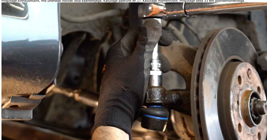
19 Pingutage roolilati otsa lukustusmutrit. Kasutage kombivõtit Nr. 17. Kasutage kombivõtit Nr. 19. Kasutage momentvõtit. Pingutage seda 47 Nm pöördemomendiga.
