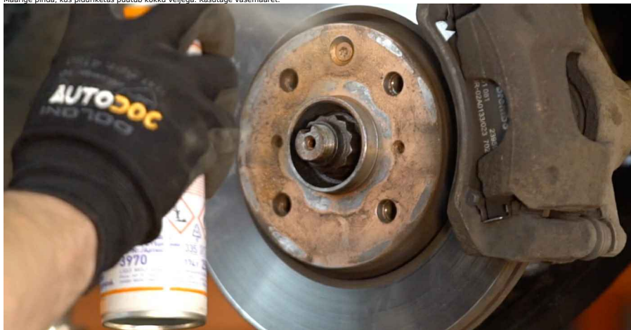
23 Puhastage ratta velgede kinnituspesad. Kasutage piduri puhastusvahendit.
