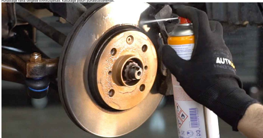
23 Puhastage ratta velgede kinnituspesad. Kasutage piduri puhastusvahendit.
