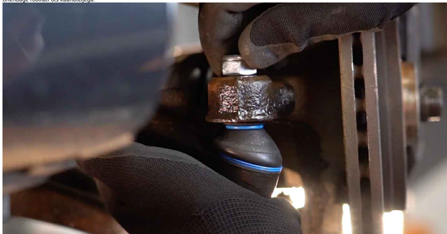
18 Pingutage kinnitusmutrit, mis ühendab roolilati otsa käändteljega. Kasutage padrunit Nr.17. Kasutage momentvõtit. Pingutage seda 33 Nm pöördemomendiga.
