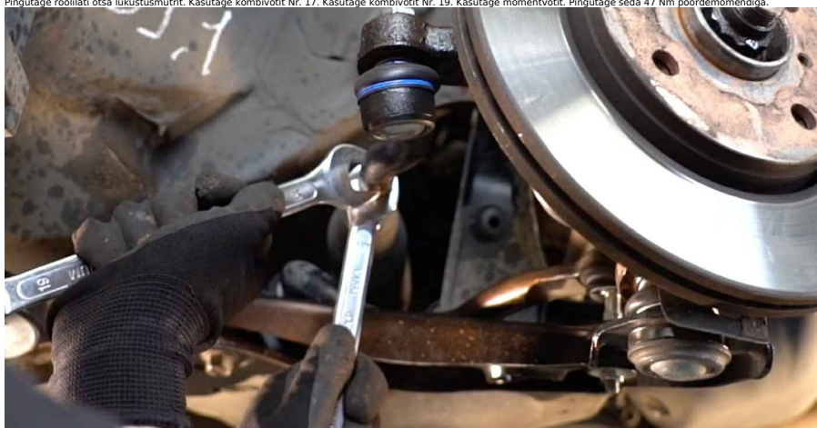
20 Paigaldage splint, mis fikseerib roolilati osta kinnituse. club.autodoc.ee 7-11
